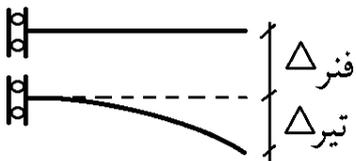
$$\Delta_{\text{کل}} = \Delta_{\text{فنر}} + \Delta_{\text{تیر}} = 24 + 36 = 60 \text{ mm}$$
