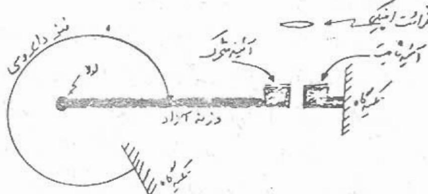
طرح فزر دارده در سطح GKA Molodenskij در گرادیت دیباگ مورد بررسی است. وقت این گرادیت صدور  $\pm 0.3$  سیکال می‌شود. طرح آن گرادیت ۴۵ درجه نسبت به قرقاچ فرقه می‌باشد. هدف این تجربه آن است که تغایر اینگاهی دستگاهی متفاوت باشد و دستگاهی مخالف قرقاچ باشد.
